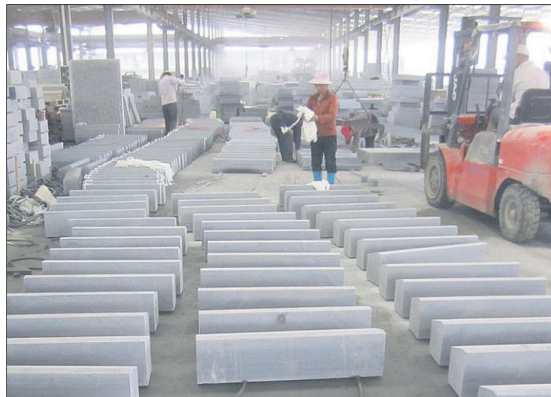
• Natuurstenen banden en ander hardsteen liggen klaar bij de Chinese groeve waar het steen is gewonnen. Inmiddels liggen ze verpakt op de gemeentelijke werf in Soest te wachten op transport naar de zuidelijke Van Weedestraat.
