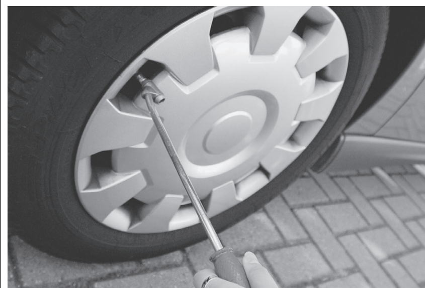
Breng de banden op de voorgeschreven (hoogste) spanning van een beladen voertuig.
